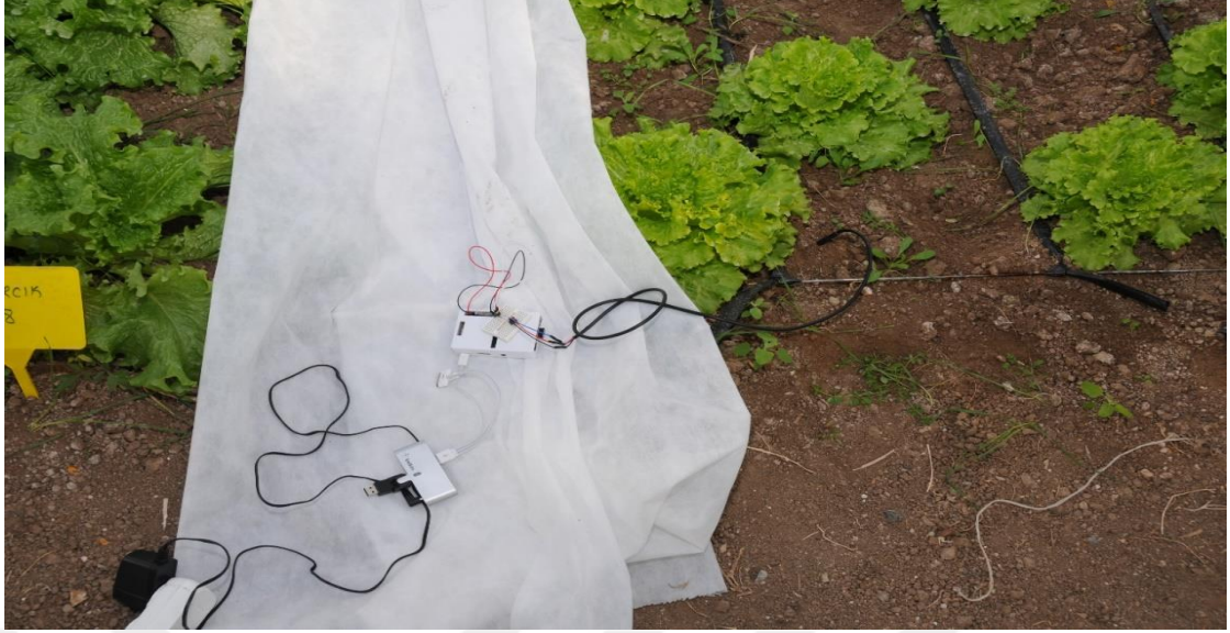
Şekil 5.20 Serada kablosuz sensör düğümünün kurulumu
