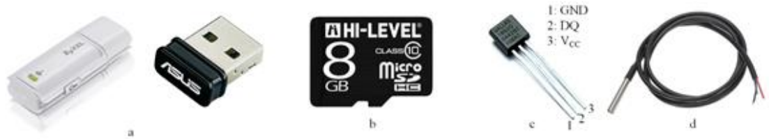
Şekil 4.2.a USB Wi-fi adaptörleri, b. MicroSD kart, c. DS18B20 sayısal sıcaklık sensörü, d. Su geçirmez DS18B20
