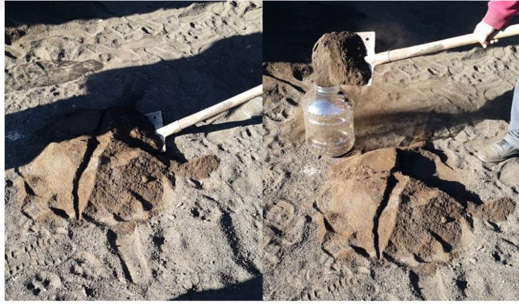
Şekil 3.1. Numune alma işlemi
