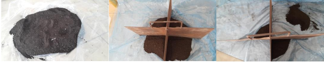
Şekil 3.3. Numune azaltma konileme-dörtleme işlemi
