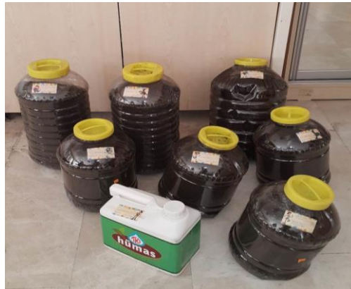
Şekil 3.2. Leonardit numunelerinin orijinal nemini koruması için kapalı kaplarda saklanması.
