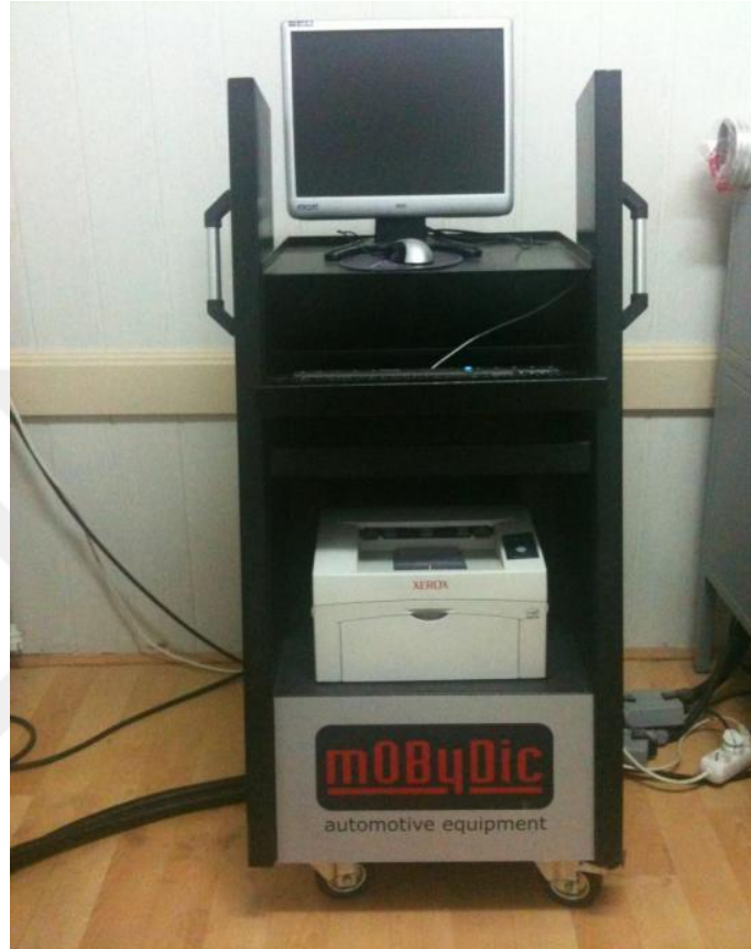
Şekil 3.26. Egzoz ölçüm cihazı
