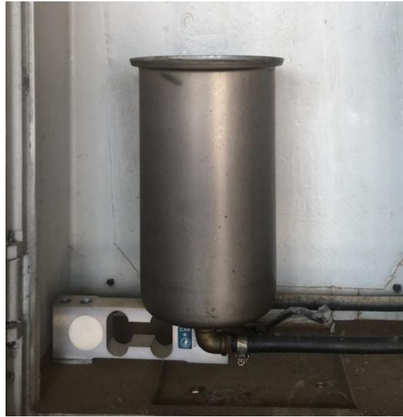
Şekil 3.24. Kütlesel ölçüm cihazı
