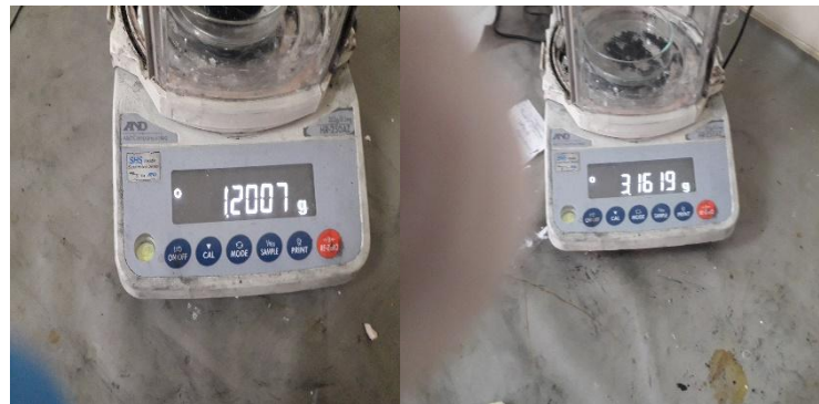
Şekil 3.17. Nanoparçacıkların hassas terazide tartılması
