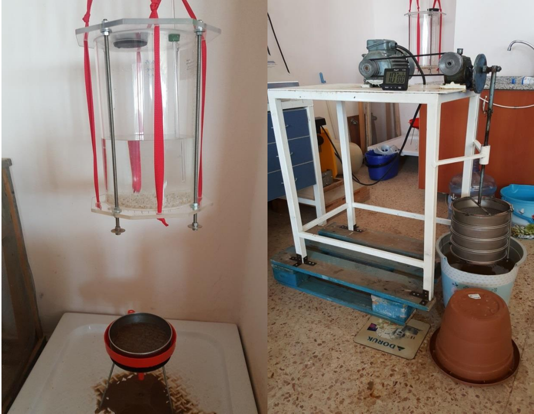
Resim 10. Soldaki resim yapay yağmur ile agregat stabilitesinin tayini ve sağdaki resim ıslak eğleme ile ağırlıklı ortalama çap tayini
