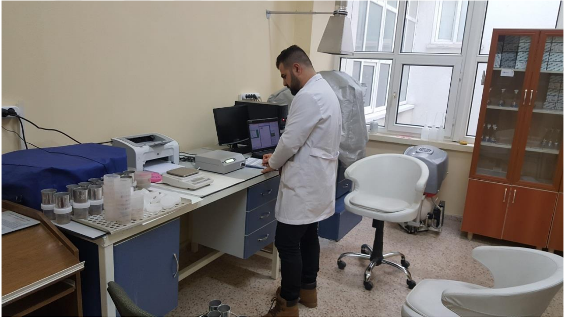
Resim 8. WP4C cihazında 6-18 pF arısındaki tutulan nemin ölçmesi
