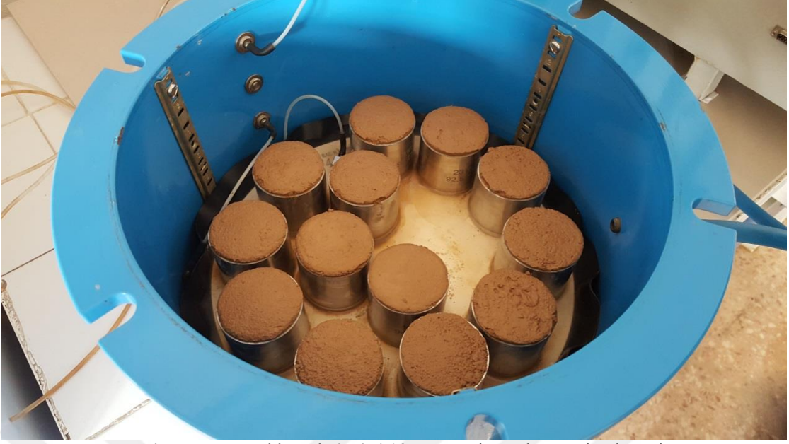
Resim 7. Basınç tablasında 2.52-4.18 pF arısında tutulan nemin ölçmesi
