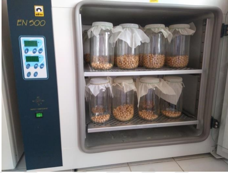
Şekil 6. Callosobruchus maculatus 'un yetiştirilmesinde kullanılan kavanozlar ve Nüve EN500 markalı inkübatör (orijinal).
