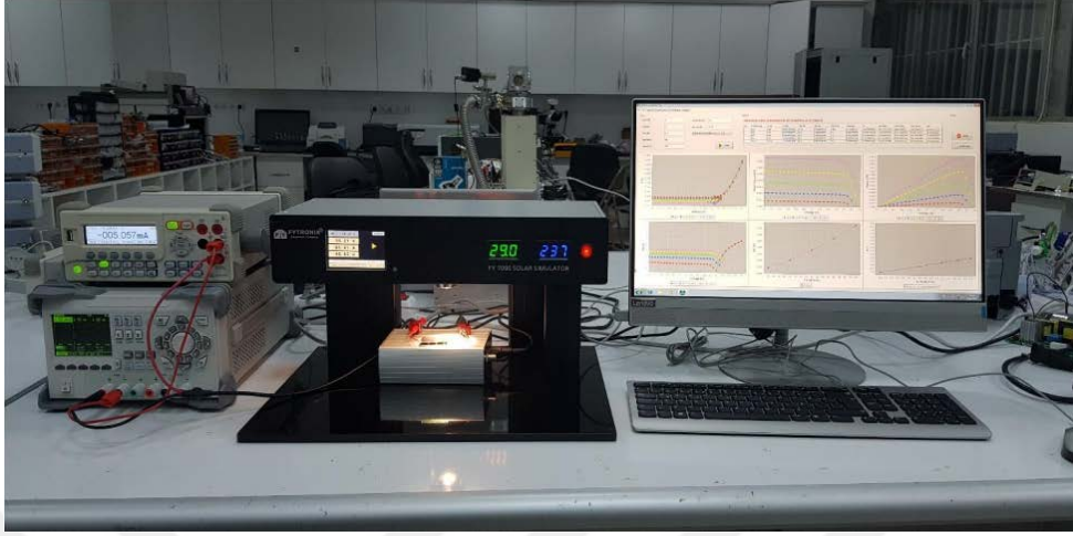
Şekil 4.3 Au/ZnO/p-Si ve Au/PTCDI-C8:ZnO/p-Si heteroeklem yapılarının, I - V karakteristiklerinin karanlık ve 20 -100 mW/cm 2 ışık şiddeti aralığında elde edilmesi için kullanılan Fytronix SS-7000 Solar Simulator ölçüm sistemi
