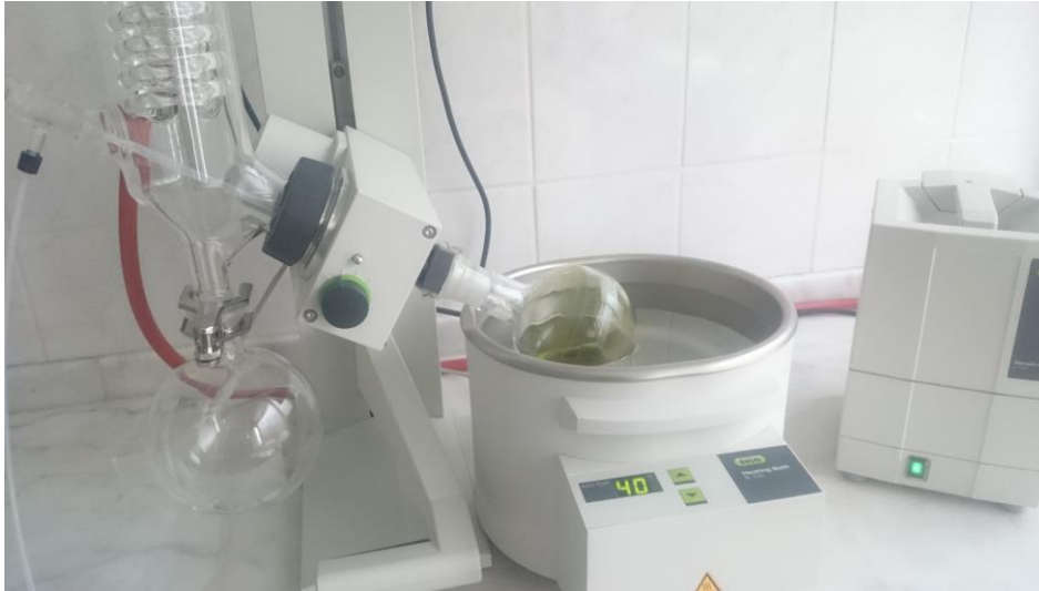
Şekil 11. Süzöntülerin rotary evaporatörde uçurulması
