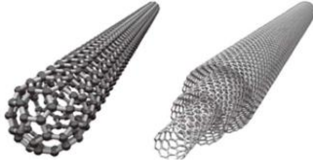
Şekil 1.2. Tek duvarlı ve çok duvarlı karbon nanotüp (Cividanes ve ark., 2014)
