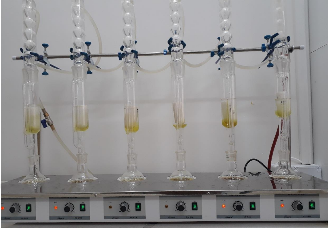
Şekil 3.35. Tohumlarda soxhlet cihazı ile yapılan yağ analizinden bir görünüm (Orijinal).
