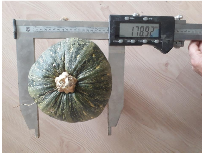
Şekil 3.25. Dijital kumpas yardımıyla meyve eni ölçümünden bir görünüm (Orijinal).
