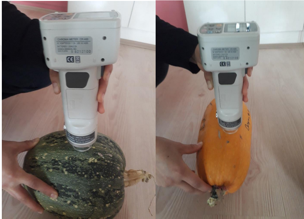
Şekil 3.26. Chroma Meter CR-400 renk tayin cihazı ile meyve kabuk rengi ölçümünden bir görünüm (Orijinal).
