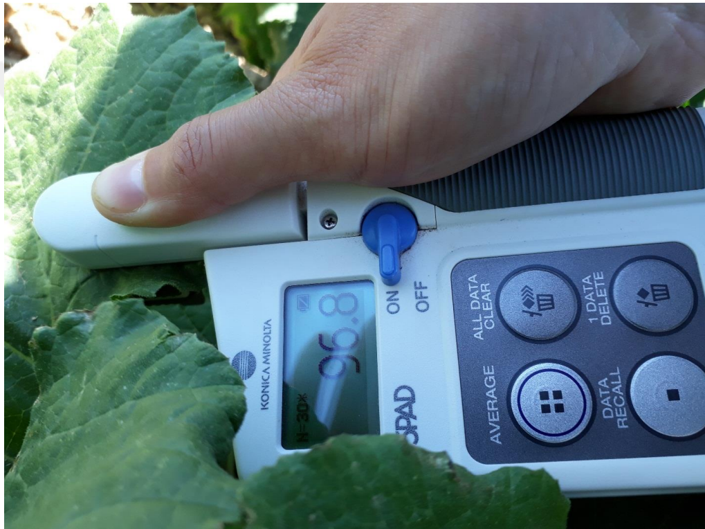
Şekil 3.32. SPAD metre ile bitkilerde klorofil ölçümlerinin yapılmasından bir görünüm (Orijinal).
