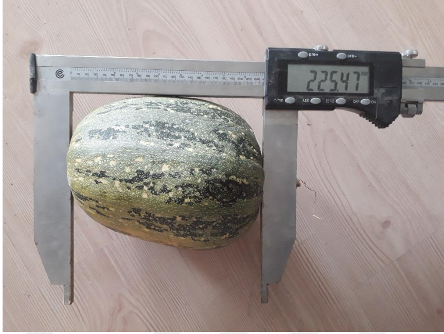
Şekil 3.24. Dijital kumpas yardımıyla meyve boyu ölçümünden bir görünüm (Orijinal).
