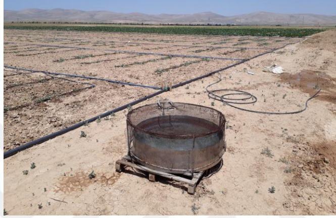
Şekil 3.9. Deneme arazisinde sulama suyunun hesaplanmasında kullanılan Class-A pan (Orijinal).
