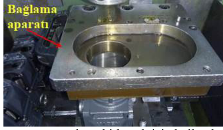
Şekil 5.3. İş parçasını tezgaha sabitlemek için kullanılan aparat takımı
