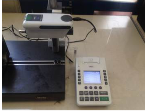
Şekil 5.5. Mahr M400 yüzey pürüzlülük ölçüm cihazı
