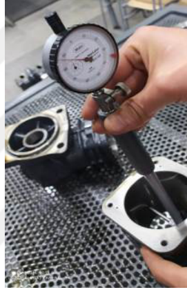
Şekil 5.4. Komparatör saati ile yapılan ölçüm
