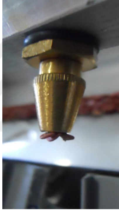
Şekil 4.3 0.5 mm çapındaki memede çoklu tohum tutulması
