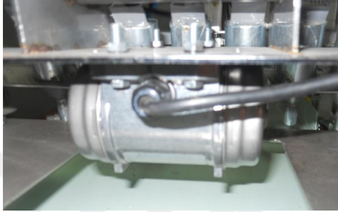
Şekil 3.11 Tohum tablasının altına monte edilmiş vibratör
