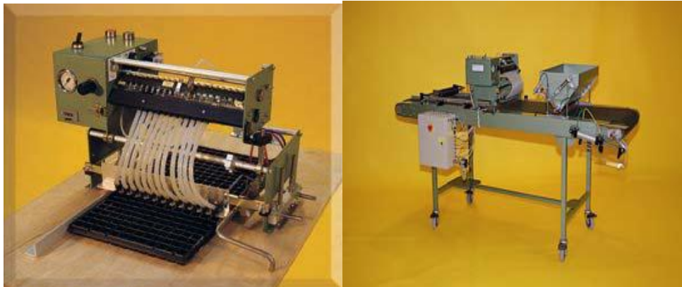
Şekil 1.6 Sadece ekim ünitesi (solda) ve ekim ünitesi ile vermikulitle örtme ve sulama ünitelerinin ayrı ayrı tasarlandığı (sağda) viyole ekim makinaları (www.hamilton-design.co.uk, 2014d)
