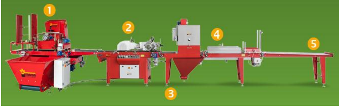
Şekil 1.7 Tam otomatik viyole ekim makinası (www.agroweld.com, 2014e) ( 1. Viyol alma ve doldurma ünitesi, 2. Tohum yatağı baskı tekeri ve tamburlu tip ekim ünitesi, 3. Vermikulit atım, örtme ünitesi, 4. Islatma ünitesi, 5. İstifleme ünitesi)
