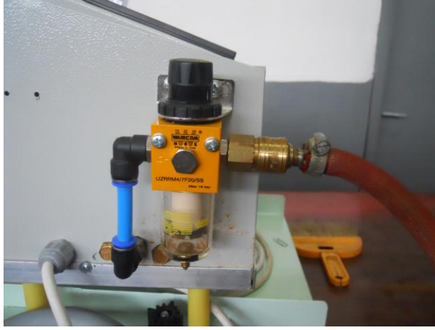
Şekil 3.5 Filtre regülatör ve hava giriş bağlantısı
