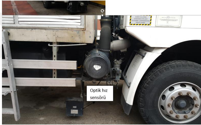
Şekil 3.5 Çeki test aracı optik hız sensörü
