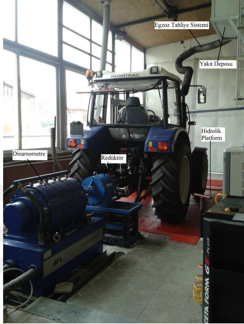
Şekil 3.1 OECD Kod 2 kuyruk mili performans test sistemi
