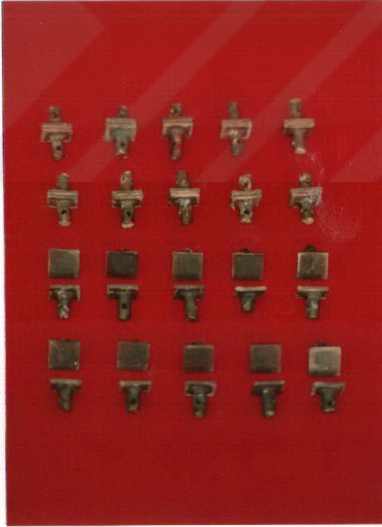
Resim 8: 1x1 cm boyutlarında hazırlanan metal döküm örnekler
