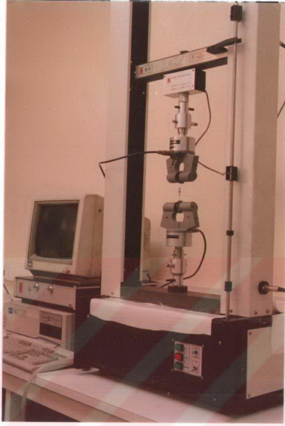
Resim 6: NENE M5 Universal Tester çekme aleti
