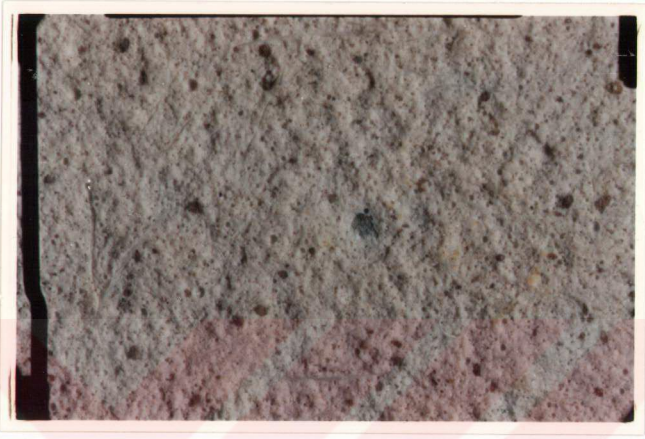
Resim 10: Polikarboksilat simanın (Poly-F Plus) metal yüzeylerdeki koheziv tipdeki kopması (x16).
