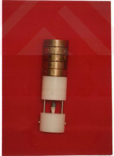
Resim 9: Örneklerin standart yük altında simante edilmesi.
