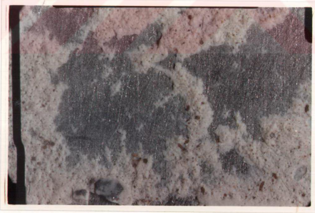
Resim 11: Polikarboksilat simanın (Poly-F Plus) metal yüzeylerdeki koheziv / adheziv tipdeki kopması (x16)
