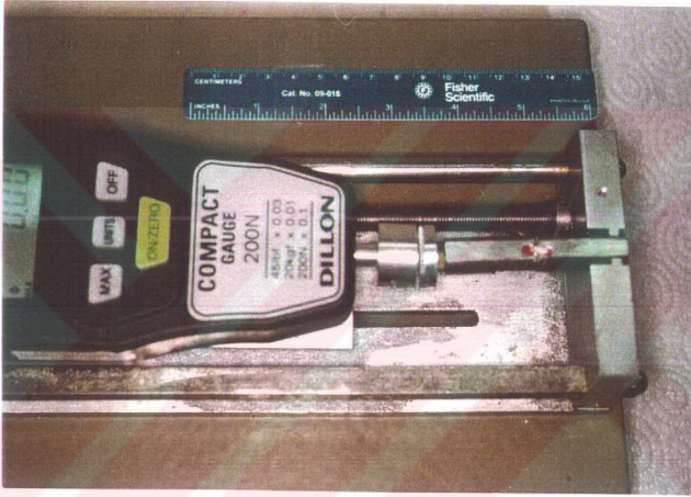
Resim 3.6. Örnekler microtensile testine tabi tutulurken
