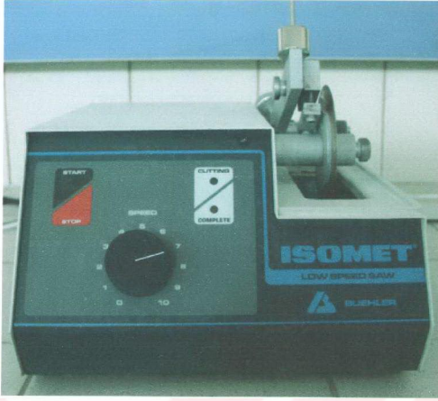
Resim 3.1. Dişleri kesmek için kullanılan düşük hızlı, su soğutmalı kesit makinesi
