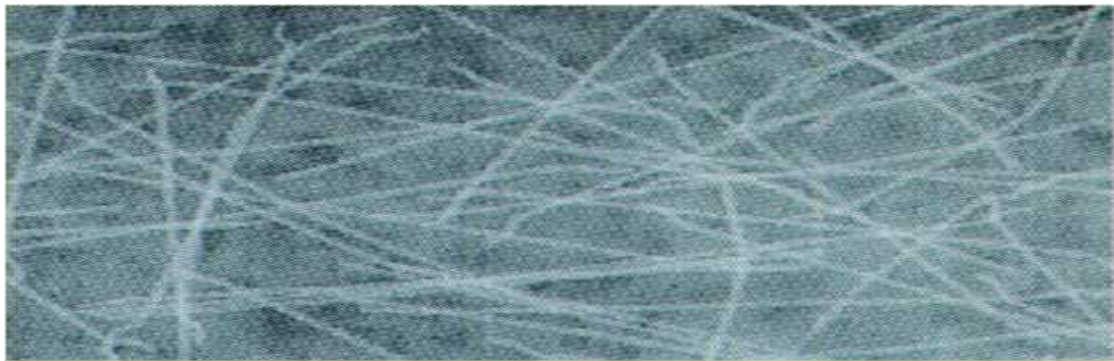
Şekil 2. 6. Çelik liflerin beton içindeki dağılımı
