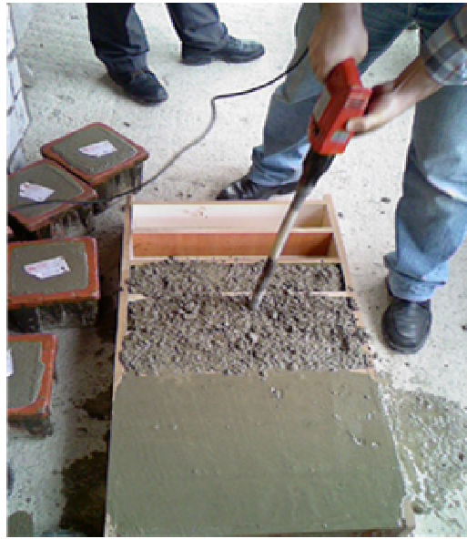
Şekil 3. 9. Karışımında kullanılacak çelik lifli numunenin kalıba yerleştirilmesi
