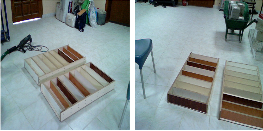
Şekil 3. 5. Numune ahşap kalıpları
