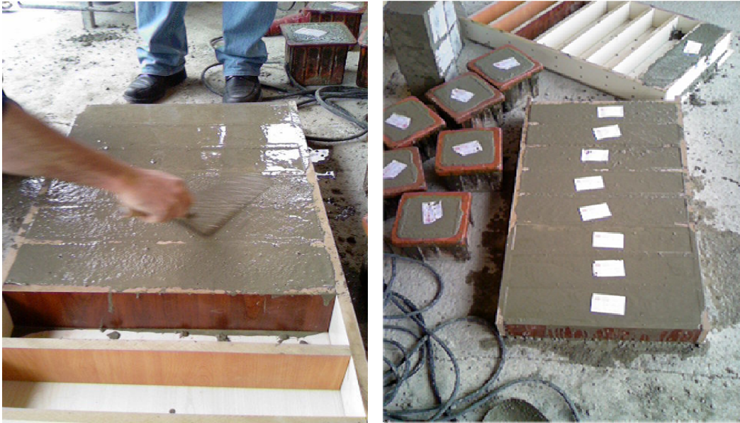
Şekil 3. 10. Kalıplara dökülen çelik lifli betonun yüzeyinin düzeltilmesi ve numaralandırılması
