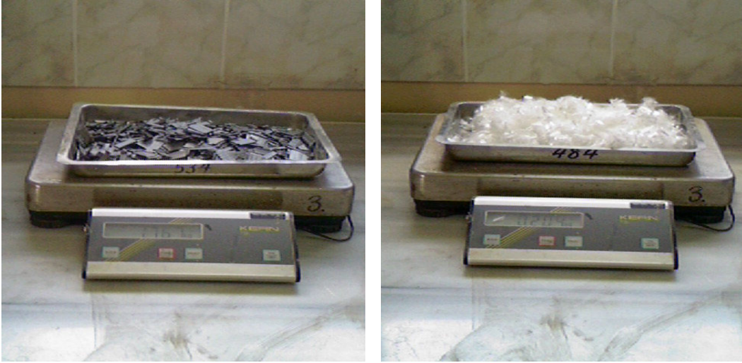
Şekil 3. 8. Karışımında kullanılacak çelik ve polipropilen liflerin terazide tartılması
