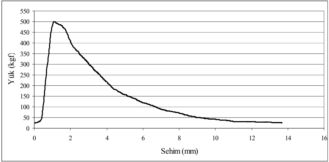
Şekil 4.14. Yüzde 1,5 çelik lifli 2 nolu numuneye ait yük -sehim grafiği
