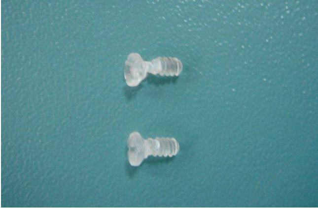
Resim 4.4 Üçüncü grupta fraktür hattının distalindeki vidalarda oluşan deformasyon
