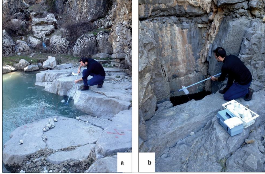
Şekil 3.5 a. Böğet, b. Yağini kaynak noktalarında su örnekleme
