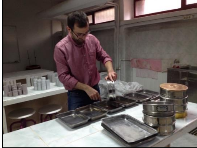
Şekil 3.10 Islak elek yöntemi ile tane boyu dağılım analizinin yapılması
