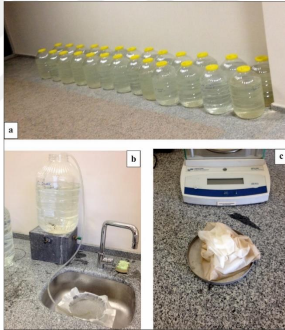
Şekil 3. 8.a. TSS analizi süreci, analiz için alınan su numuneleri, b. filtreleme işlemi, c. etüvde kurutulduktan sonra filtrenin tartılması
