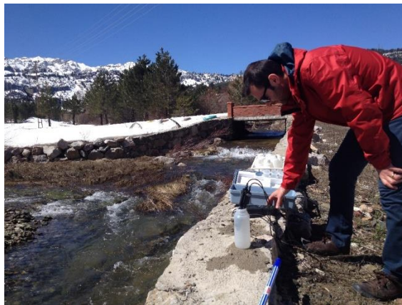
Şekil 3.4 Kaynak başında fizikokimyasal parametrelerin ölçümü
