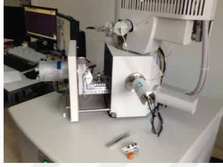
Şekil 3.9 FEI Quanta 400 MK2 SEM, EDAX GenesisXM4i EDS Analiz cihazı (MTA Laboratuvarı)
