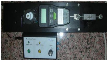
Resim 3.13. Bisco micro Tensile tester cihazı
