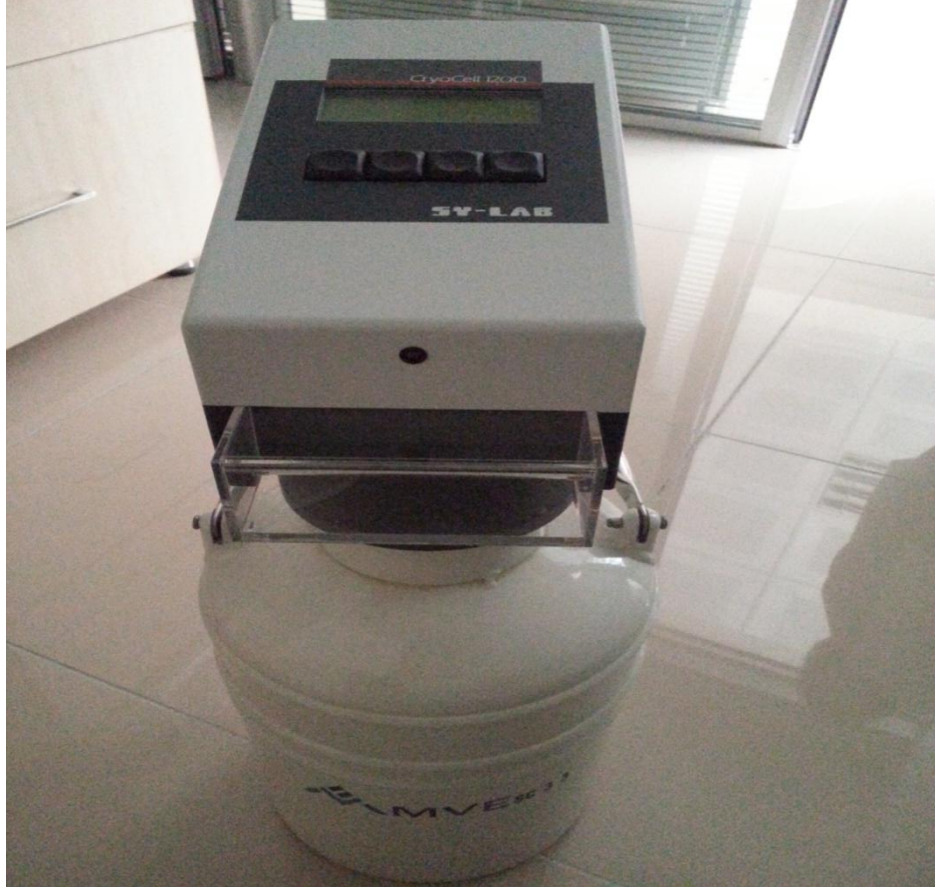
Resim 2.2.4.1. Cryocell embriyo dondurma cihazı. (Çizmecı SÜ, Selçuk Üniversitesi Veteriner Fakültesi Doğum ve Jinekoloji Anabilim Dalı, 2012).
