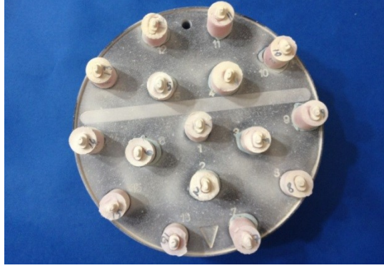
Resim 2.11. Optik tarayıcı için hazırlanan örnekler
