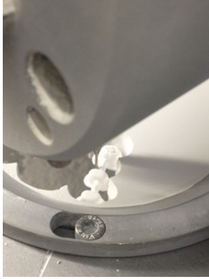
Resim 2.15. Aşındırılan zirkonya blok
