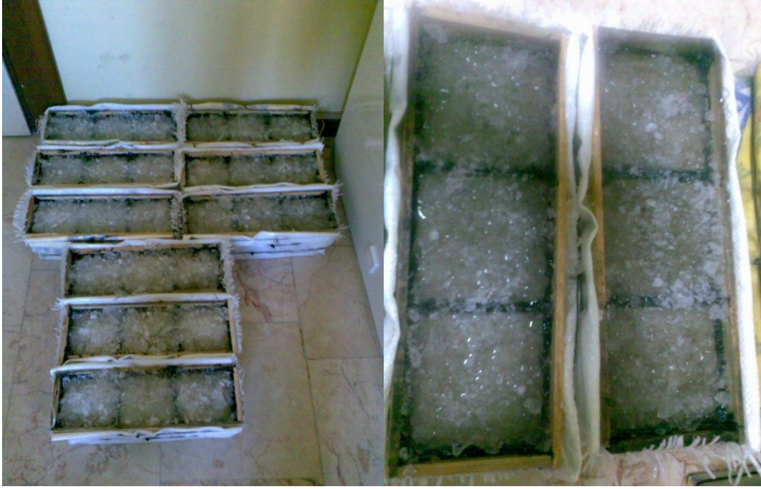
Şekil 5.10. Derin dondurucudan çıkartılan numuneler tuz serpilerek erimeye bırakılmış hali
