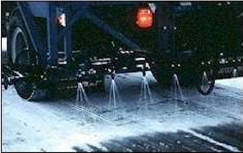
Şekil 4.4. Sıvı kimyasalların uygulandığı püskürtme sistemine örnek
