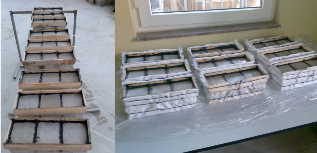
Şekil 5.5. Numunelerin gruplar halinde yüzey havuzu elde edilmesi ve çuval kaplanması
