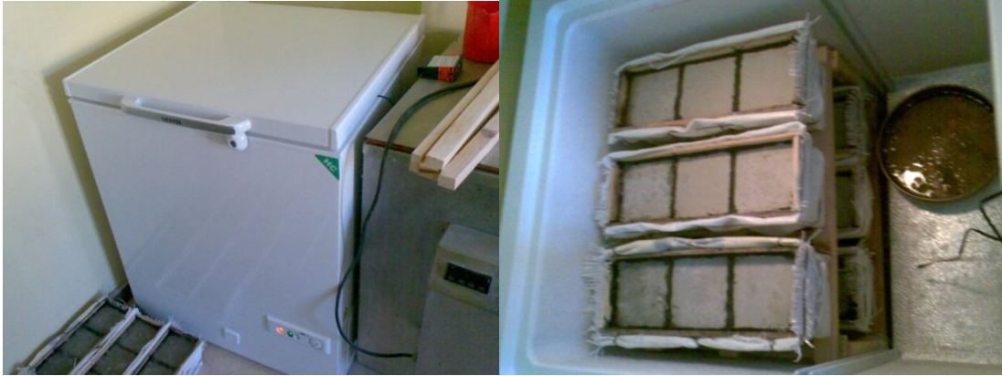
Şekil 5.6. Derin dondurucu ve numunelerin derin dondurucu içindeki görüntüsü
