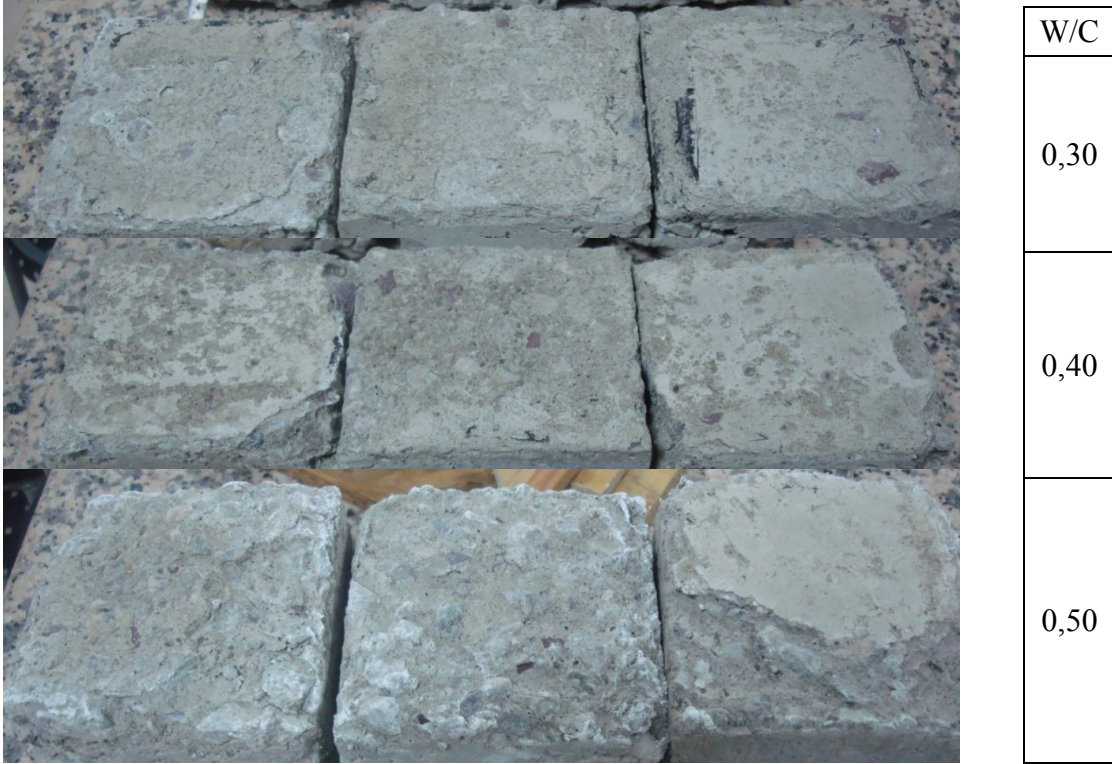
Şekil 6.2. Akışkanlaştırıcı katkılı numunelerin etüvden çıktıktan sonraki yüzey görüntüleri
