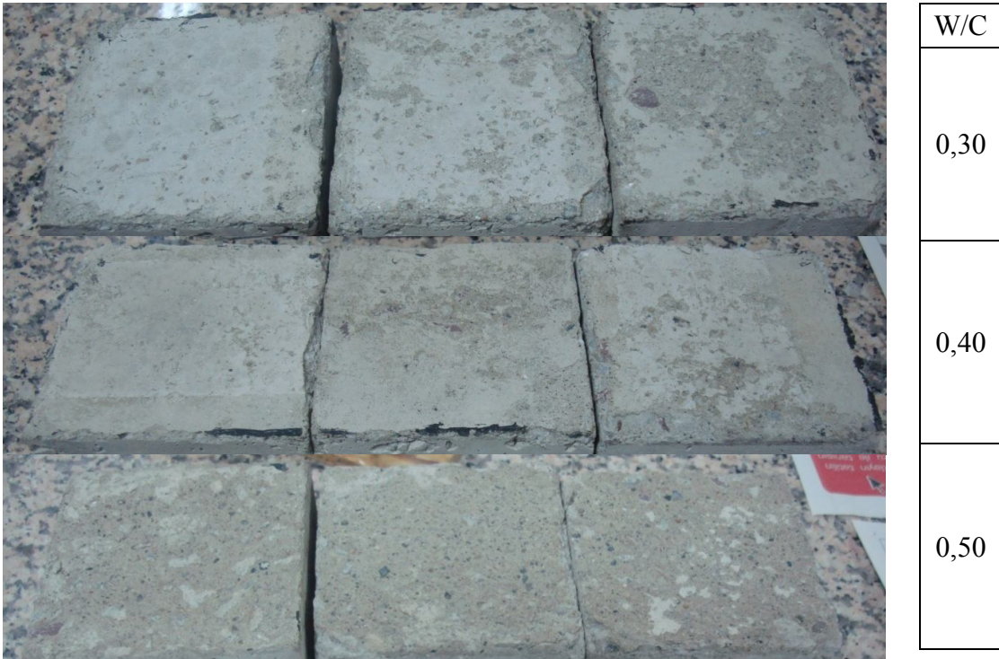
Şekil 6.3. Akışkanlaştırıcı ve hava sürükleyici katkılı numunelerin etüvden çıktıktan sonraki yüzey görüntüleri
