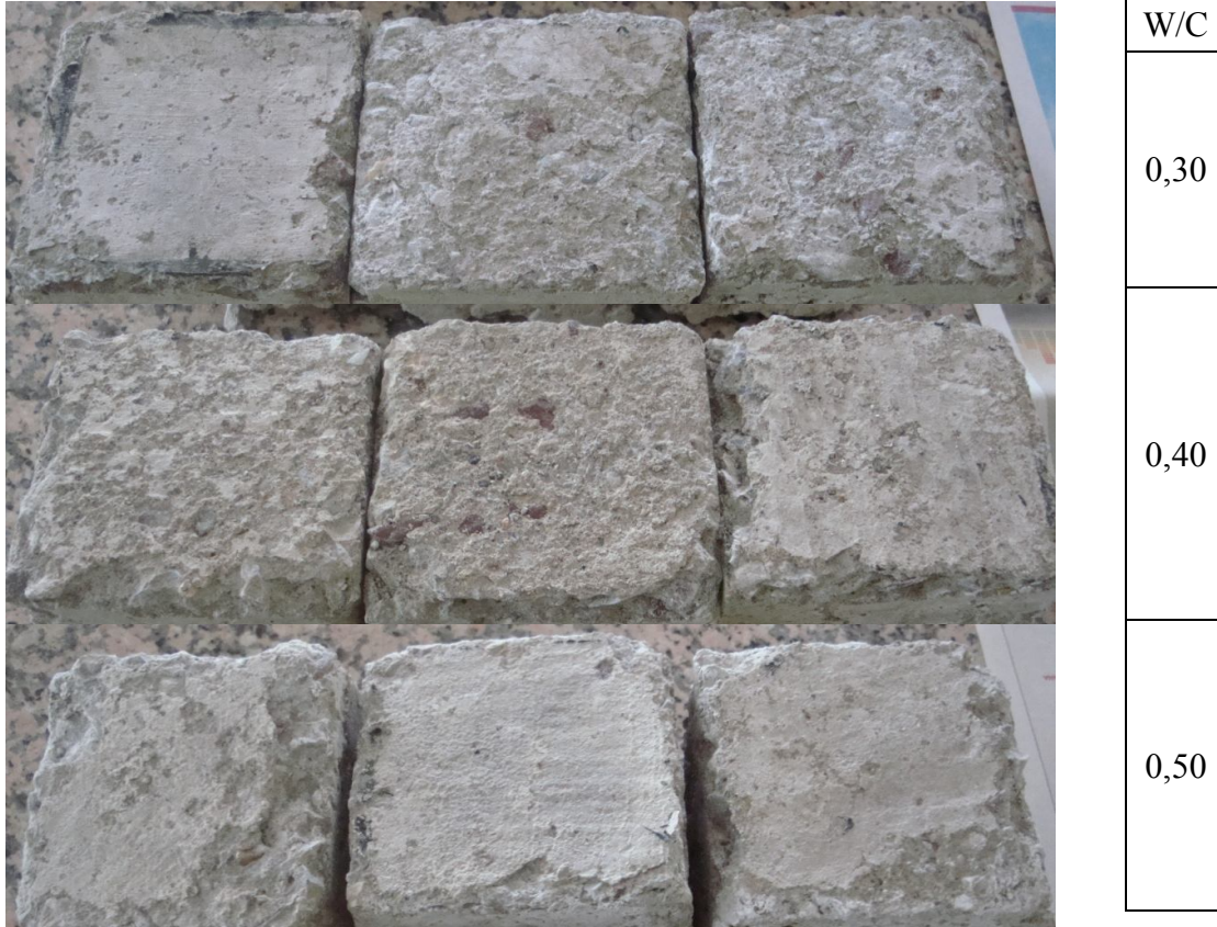
Şekil 6.1. Katkısız numunelerin etüvden çıktıktan sonraki yüzey görüntüleri
