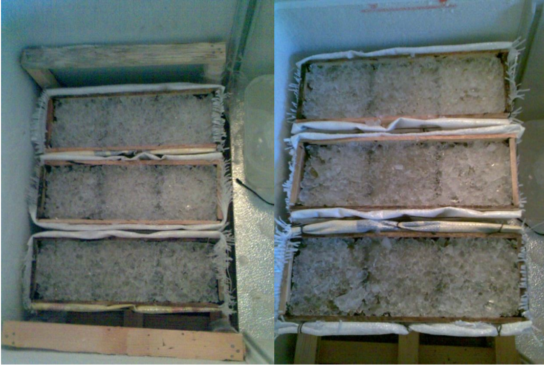
Şekil 5.9. Derin dondurucunun içindeki numunelerin görüntüsü (alt ve üst kak)
