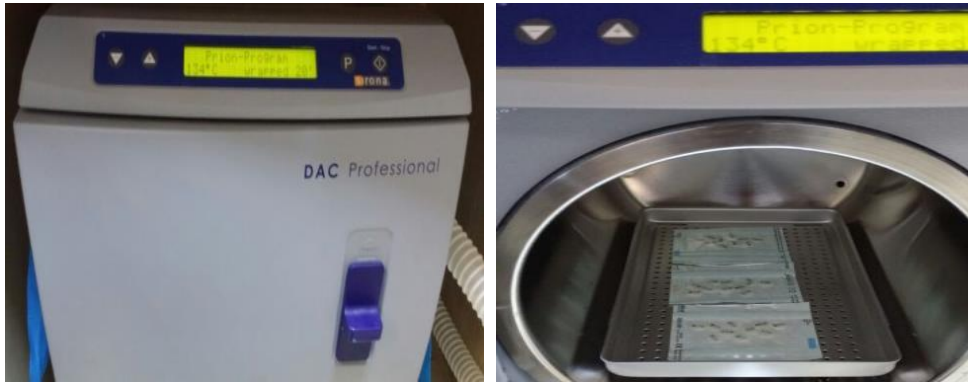
Şekil 2.14. Örneklerin buharlı otoklavda bekletilmesi.
