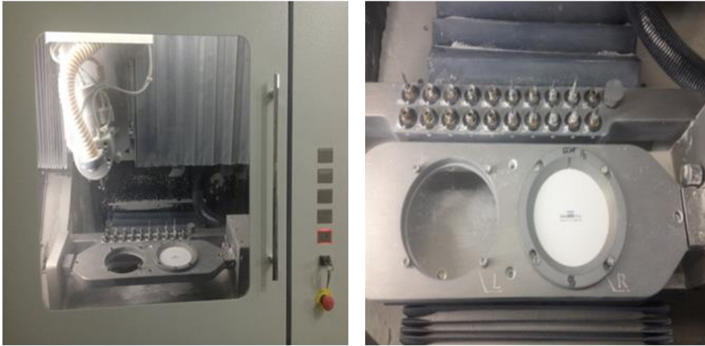
Şekil 2.4. Disklerin frezeleme ile şekillendirilmesi.
