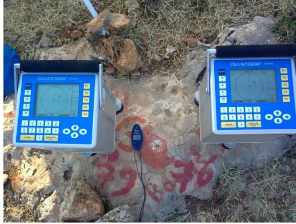
Şekil 4.7. Gravimetrelerin çekül doğrultusunda getirilerek en az 10 dk. bekletilmesi
