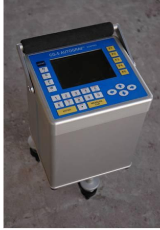
Şekil 4.4. Scintrex firması tarafından üretilen ve ölçümlerde kullanılan CG5 AutoGRAV model gravimetre sistemi
