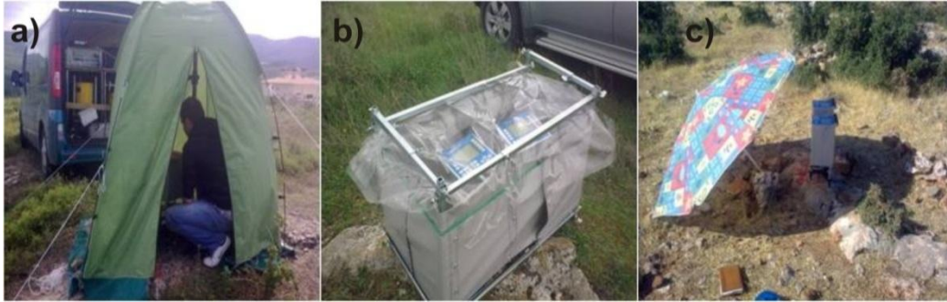
Şekil 4.8. Gravimetrik ölçümlerde alınan bazı önlemler. (a) çadır kullanımı, (b) platform kullanımı, (c) şemsiye kullanımı.
