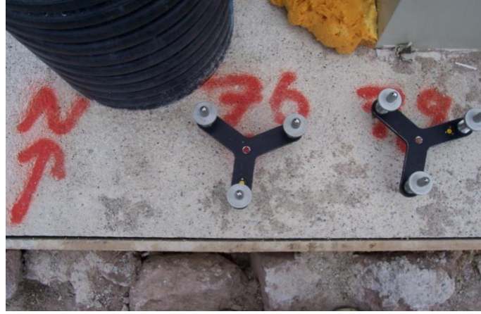
Şekil 4.5. Üç ayak ile nokta merkezinin çakıştırılması
