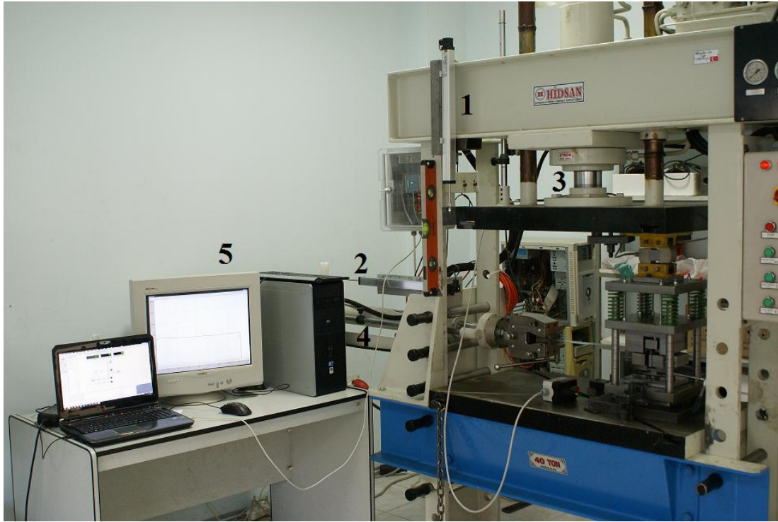
řekil 3.2. Modernize edilmiř 40 tonluk atlye tipi pres
