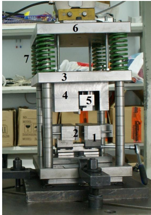
Şekil 3.5. Pres alt tablasına yerleştirilen kalıp seti
