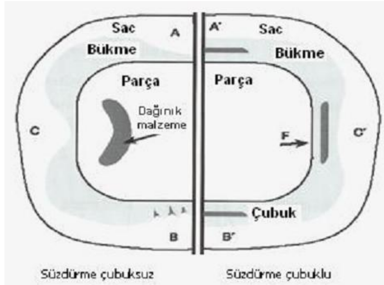
Şekil 1.6. Süzdürme çubuğunun kullanıldığı ve kullanılmadığı durumların karşılaştırılması [6]
