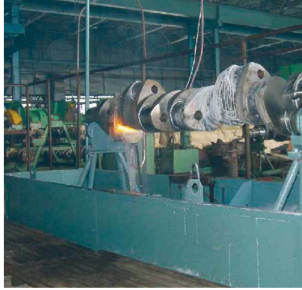
Şekil 3.15. EPT ile krankmili sertleştirme [84]
