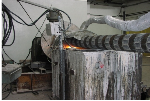
Şekil 3.13. Sondaj delme borusunun elektrolitik plazma ile sertleştirilmesi [82]
