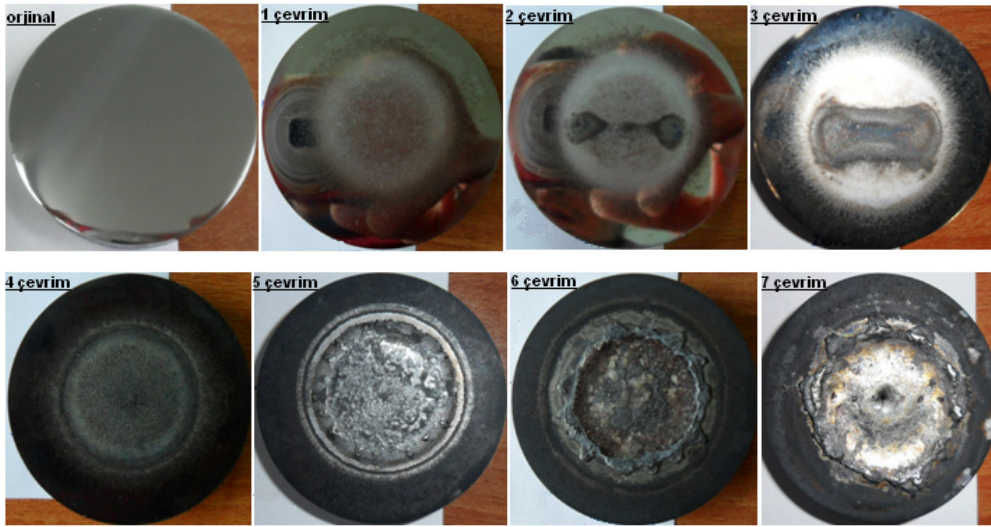
řekil 6.36. 4140 eliđi, EPT 1-7 evrimleri sonrası numune yuzeyinde oluřan plazma spotları
