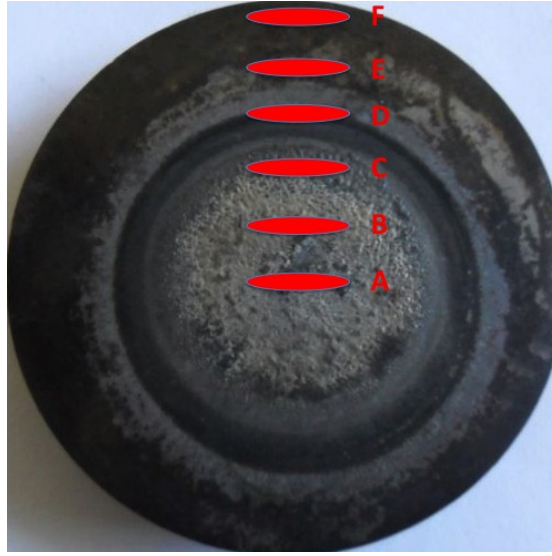
Şekil 6.58. Sertleştirme işlemi sonrasında yüzeyde oluşan spot üzerindeki farklı bölgelere ait aşınma izleri (EPT4)
