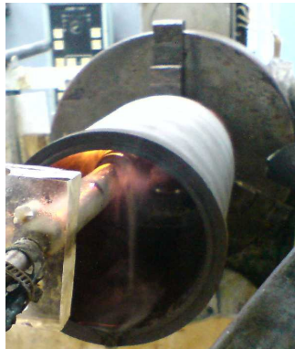
Şekil 3.14. Sondaj delme borusunun elektrolitik plazma ile iç yüzey sertleştirilmesi [82]
