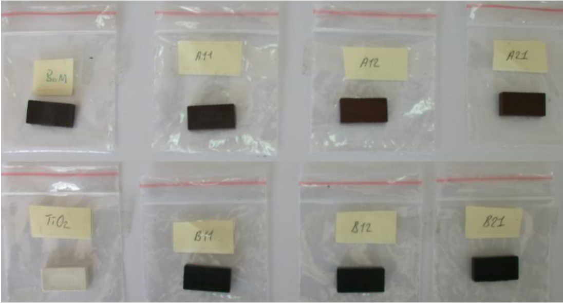
Şekil B.2. Mikrodalga ölçüm öncesi pencereye uygun hazırlanan toz numuneler.
