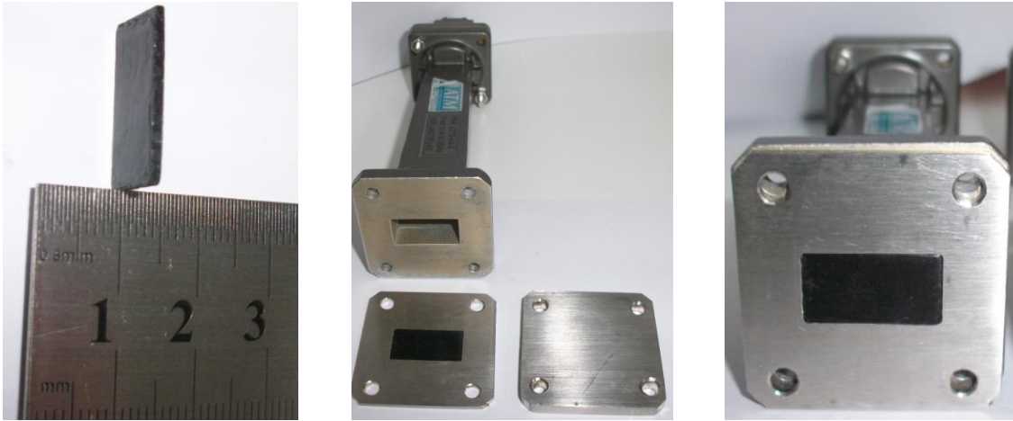
Şekil 3.3. Toz numunenin ölçüm öncesi dalga kılavuzu penceresine tam olarak yerleştirilmesi.
