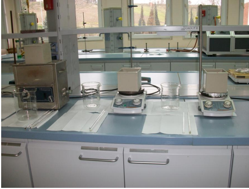
Şekil 3.7. Akımsız metal kaplama tekniği için kullanılan deney düzeneği.
