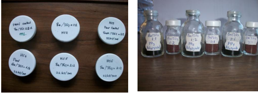
Şekil 3.2. TiO 2 karışımı PANI ve PPy kaplanmış BaM nanotozlar.
