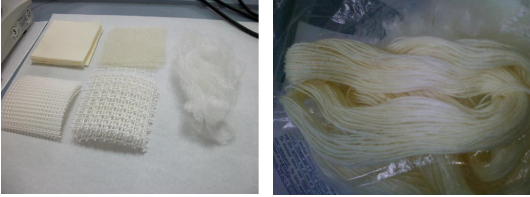
Şekil 3.8. Kaplama öncesi PAN bezlerin ve fiberlerin görünümü.
