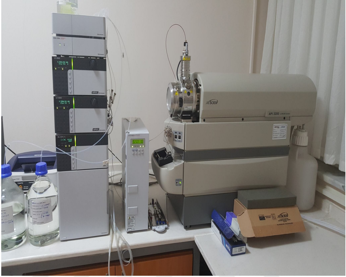
Şekil 2.1. Laboratuvarımızda kullandığımız API 3200 marka kütle spektrometre (LC-MS/MS) cihazı
