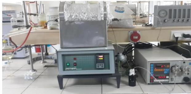
Şekil 3.2 Naftalin yağı fraksiyonu metilasyon işleminin gerçekleştiği deney sistemi
