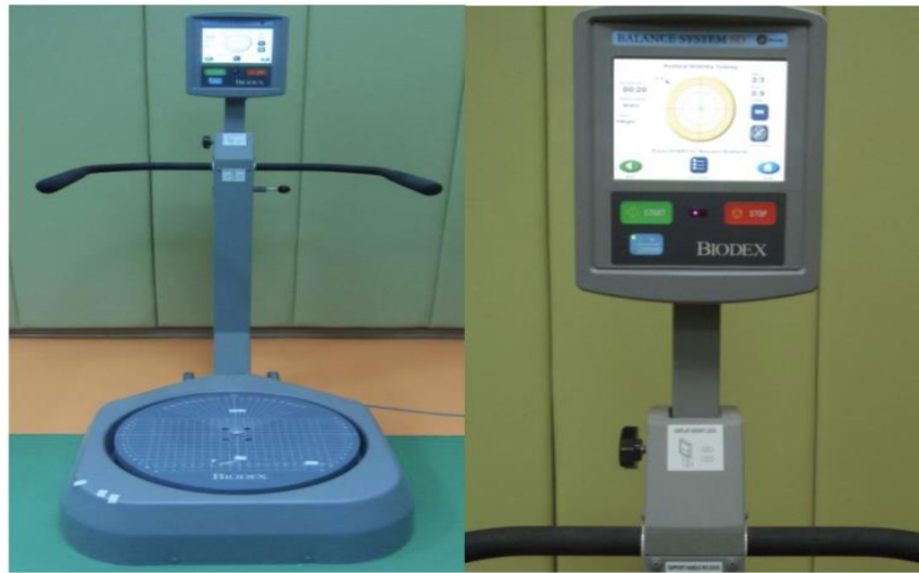
Şekil 2.7. Biodex balance system denge ölçüm aleti.
