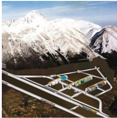
Şekil 5.2 Gran Sasso yeraltı laboratuvarının şematik görüntüsü
