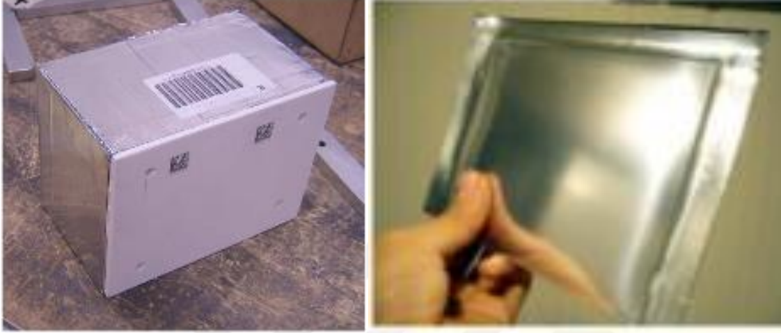
Şekil 5.7 ECC birim ve alüminyum folyo içerisinde değişebilen filmler
