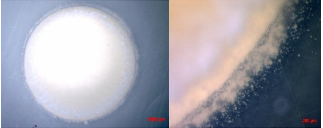
Şekil 6.23. 48 saatlik inkübasyon ardından ticari hidroksiapatit disk yüzeyinde ve etrafında meydana gelen E. coli bakteri üremesi.
