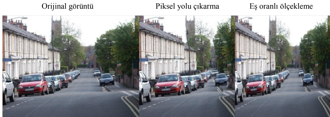
Şekil 2.5. Orijinal görüntü, piksel yolu çıkarma yöntemi ile %30 ölçeklenmiş görüntü ve klasik (eş oranlı) ölçekleme ile %30 ölçeklenmiş görüntü
