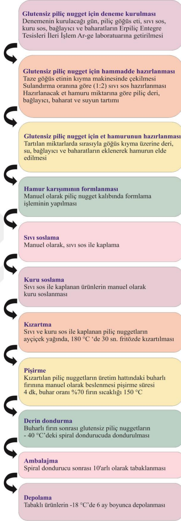
Şekil 3.6 Glutensiz piliç nuggetların üretim aşamaları
