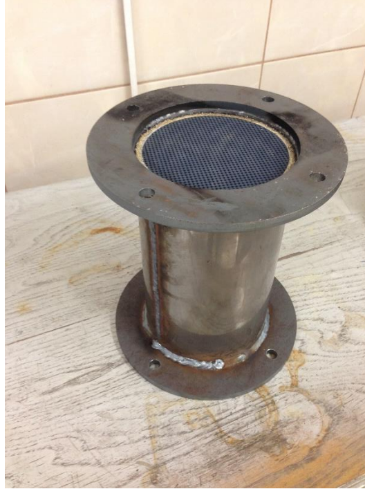
Şekil 4.1. 150 CPSI partikül filtresi
