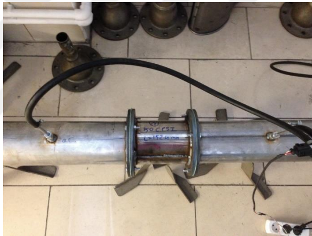
Şekil 4.5. Fark basınç sensörünün bağlantısı
