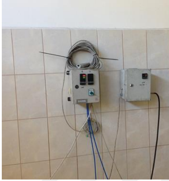
Şekil 4.6. Basınç farkı ve venturimetre değerlerini okuma ekranları
