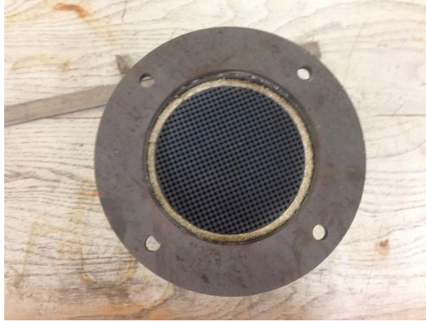
Şekil 4.2. 90 CPSI partikül filtresi
