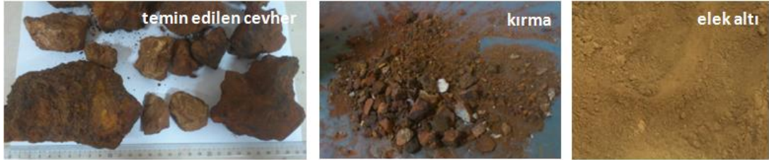
Şekil 4.1. Temin edilen cevherin deneylere hazırlanması.
