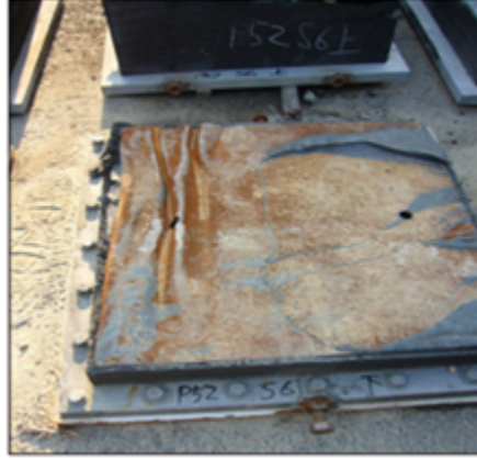
Şekil 2.23. Elastomerik mesnet hasarı, Sendai-Tobu viyadüğü
