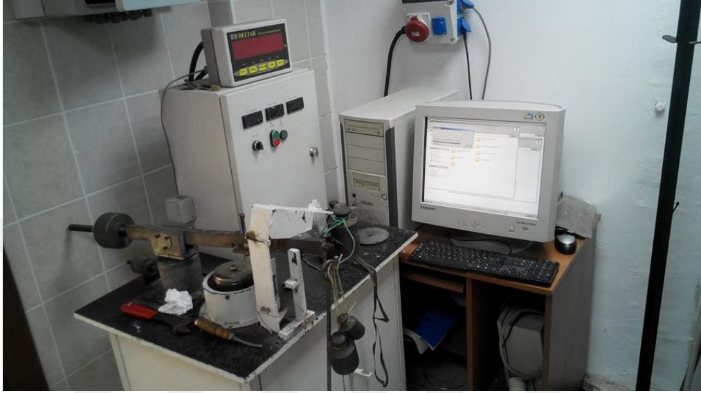
Şekil 3.7. Pin-on disk aşınma test cihazının görünümü
