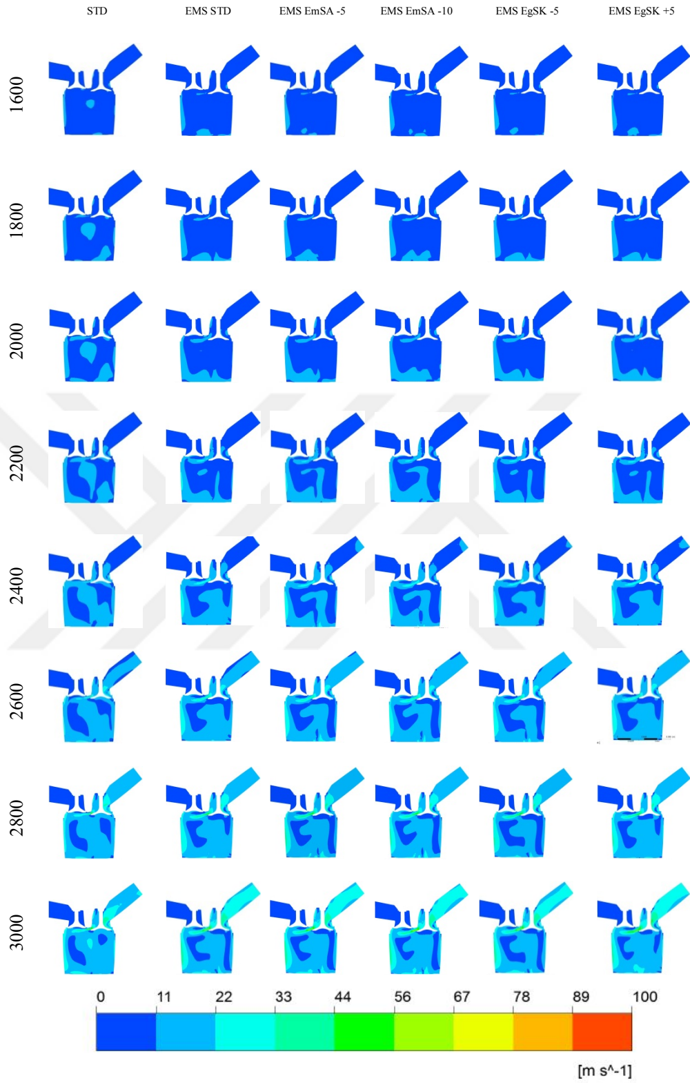
Şekil 7.6. 1260 KMA Silindir içi ve Manifold hız dağılımı
