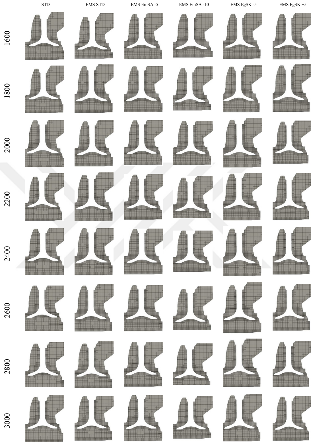
Şekil 7.2. 1120 KMA Emme Supapı Dinamik Ağ Yapısı Görüntüleri
