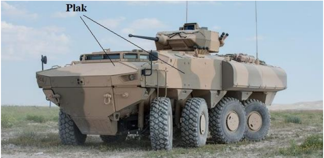
Şekil 1.2. FNSS Pars zırhlı araçında kullanılan plaklar [2]
