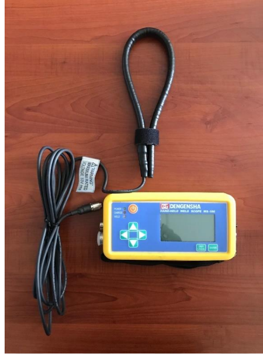
Şekil 6.4. Dengensha marka akım ölçer.
