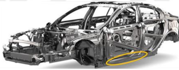
Şekil 3.3. DP800 HyperForm'un yan şase kolu olarak kullanımı.
