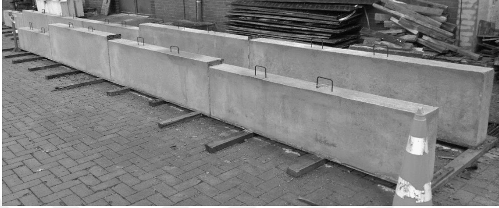
Şekil 5.14. Kalıbı sökülmüş deney numuneleri.
