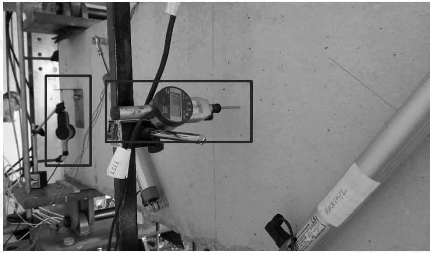
Şekil 5.20. Numunede oluşan düzlem dışı hareket ve mesnet çökmesinin ölçülmesi.
