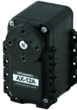
Şekil 3.3. Çalışmada kullanılan AX-12A akıllı servo motorlar.
