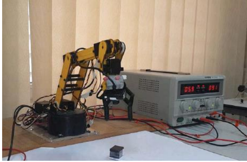
Şekil 2.10. Yosıf'ın gerçekleştirdiği robotik bilgisayar görüşüyle nesne yakalama [23].
