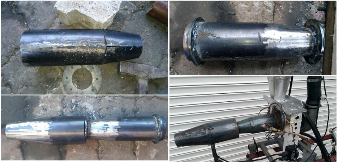
Şekil 3.20. Tasarlanan iki kademeli egzozun imalat aşamaları.
