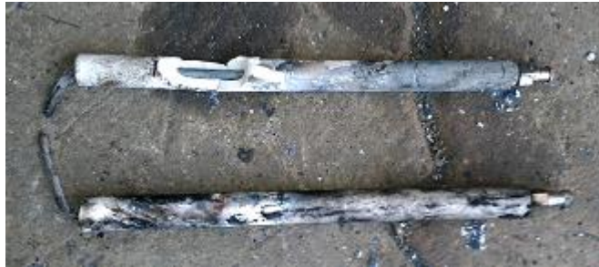
Şekil 3.13. Deneme çalışması sonrası hasar görmüş bujiler.
