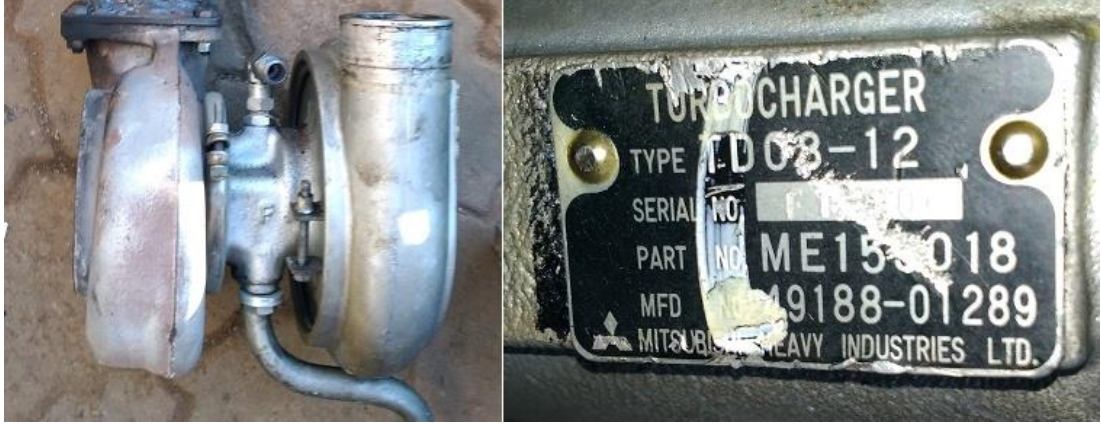
Şekil 3.4. Model turbojet motorunda kullanılan turbo şarj ünitesi.
