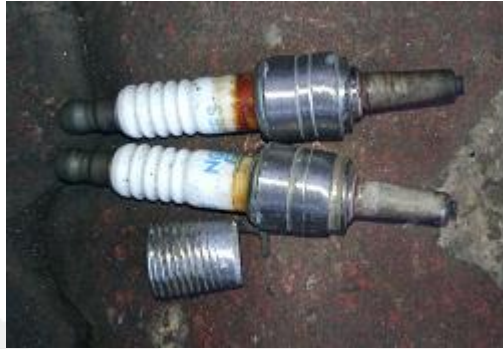
Şekil 3.14. Ateşleme sisteminde kullanılan bujiler.
