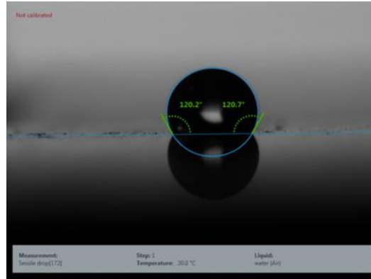
Şekil 4.6. Hidrofobik kaplamalı plakanın temas açısı ölçüm görseli
