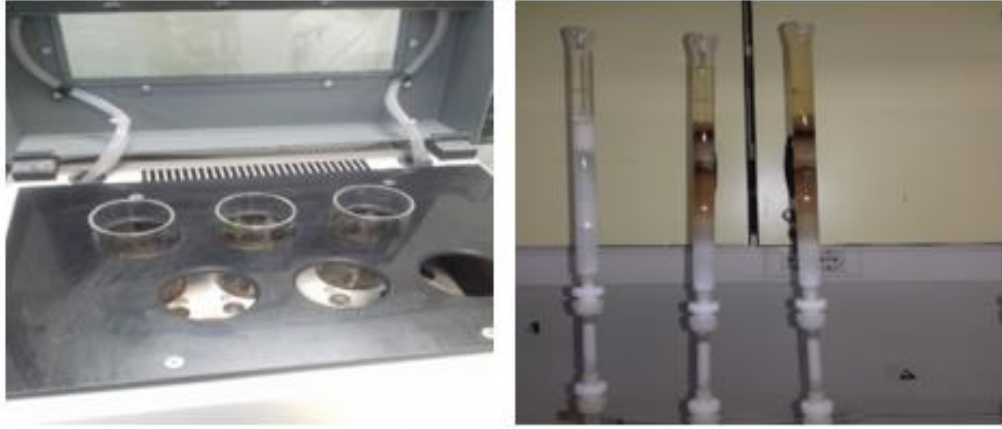
Şekil 5.8. PCDD/F analizleri için saflaştırma ve hacim deriştirme
