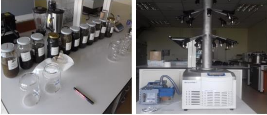
Şekil 5.4. Sediman örneklerinin kurutulması
