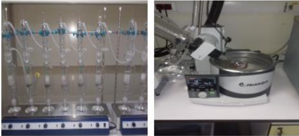
Şekil 5.6. PCDD/F analizleri için ekstraksiyon ve hacim deriştirme
