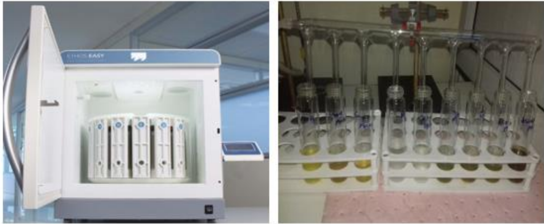
Şekil 5.9. PAH analizleri için ekstraksiyon ve hacim deriştirme
