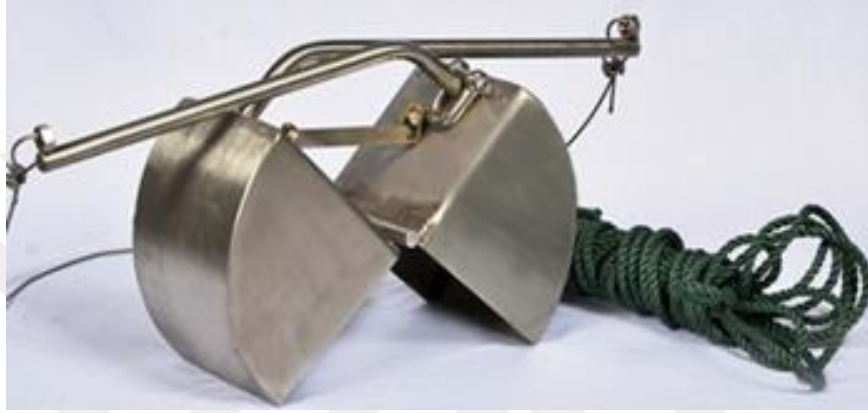
Şekil 5.2. Van-Veen sediman kepçesi (Grab)
