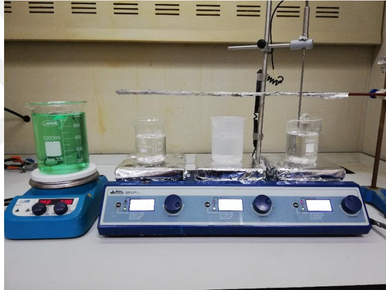
Şekil 3.3. Ni-B ve Ni-B-Al 2 O 3 kaplama işlemleri için uygulanan ön işlemlere ait banyolar.
