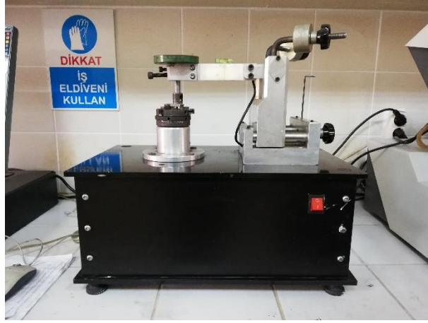
Şekil 3.4. Aşınma deneylerinde kullanılan ASTM G133-05'e uygun imal edilmiş ball-on-disc test cihazı.
