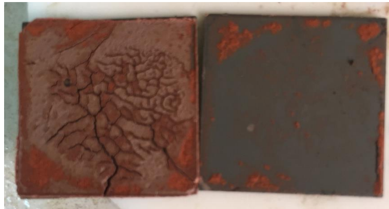
Şekil 5.30. A3 conta bileşimi ile kaplanmış ön işlem yapılmamış AISI 430 sandviç panellerin 1000°C'de 1 saat ısıtıl işlem sonrası görüntüsü
