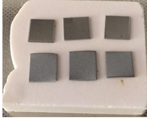
Şekil 4.12. Borlama öncesi 900°C'de 2 saat ön oksidasyon yapılan altlıklar
