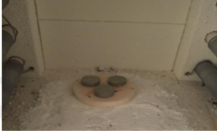
Şekil 4.5. A1, A2 ve A3 bileşimlerinden XRD incelemesi için 1000°C’de 1 saat ısıl işlem uygulanan sinter numuneler
