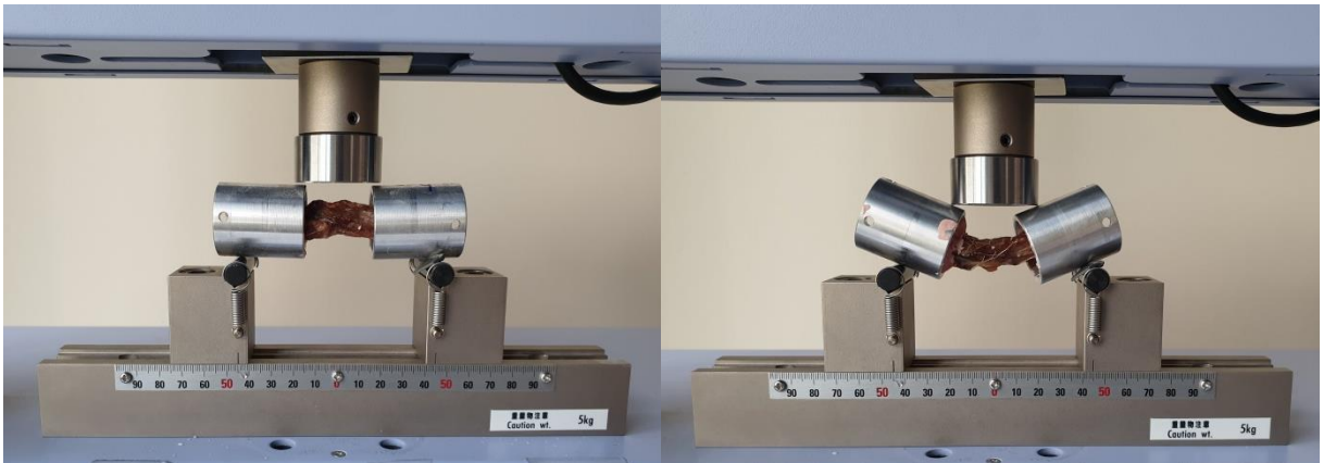
Şekil 23. Fleksiyon, ekstensiyon ve her iki düzlemde lateral bending hareketlerinin dört noktalı bükme testi ile simüle edilerek tahribatsız olarak test edilmesi
